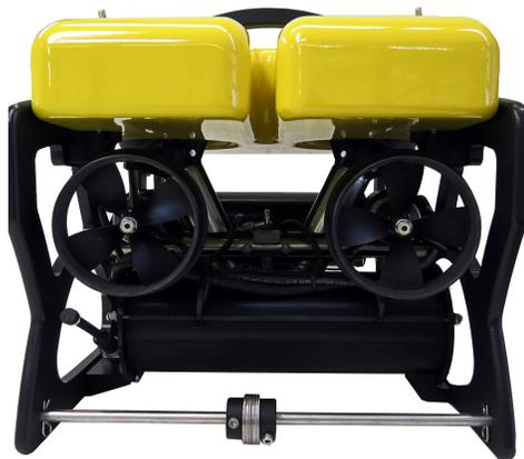
**Steelhead** 檢測級ROV是一種便攜式、輕便且穩定的水下系統，可透過直觀的控制輕鬆操作。它的外形小允許檢查密閉的空間，並容易收起。
